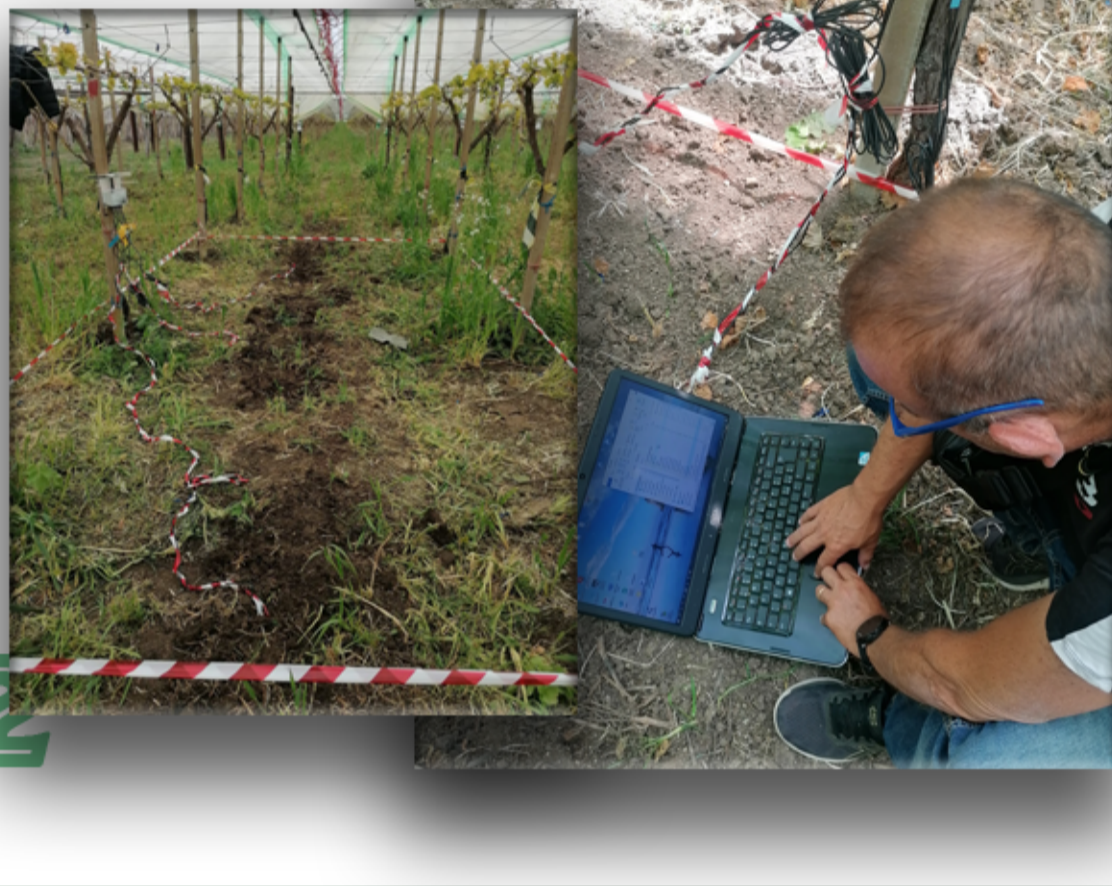
Figura 2. Monitoraggio del contenuto idrico del suolo (SWC) con sonde capacitivi.
