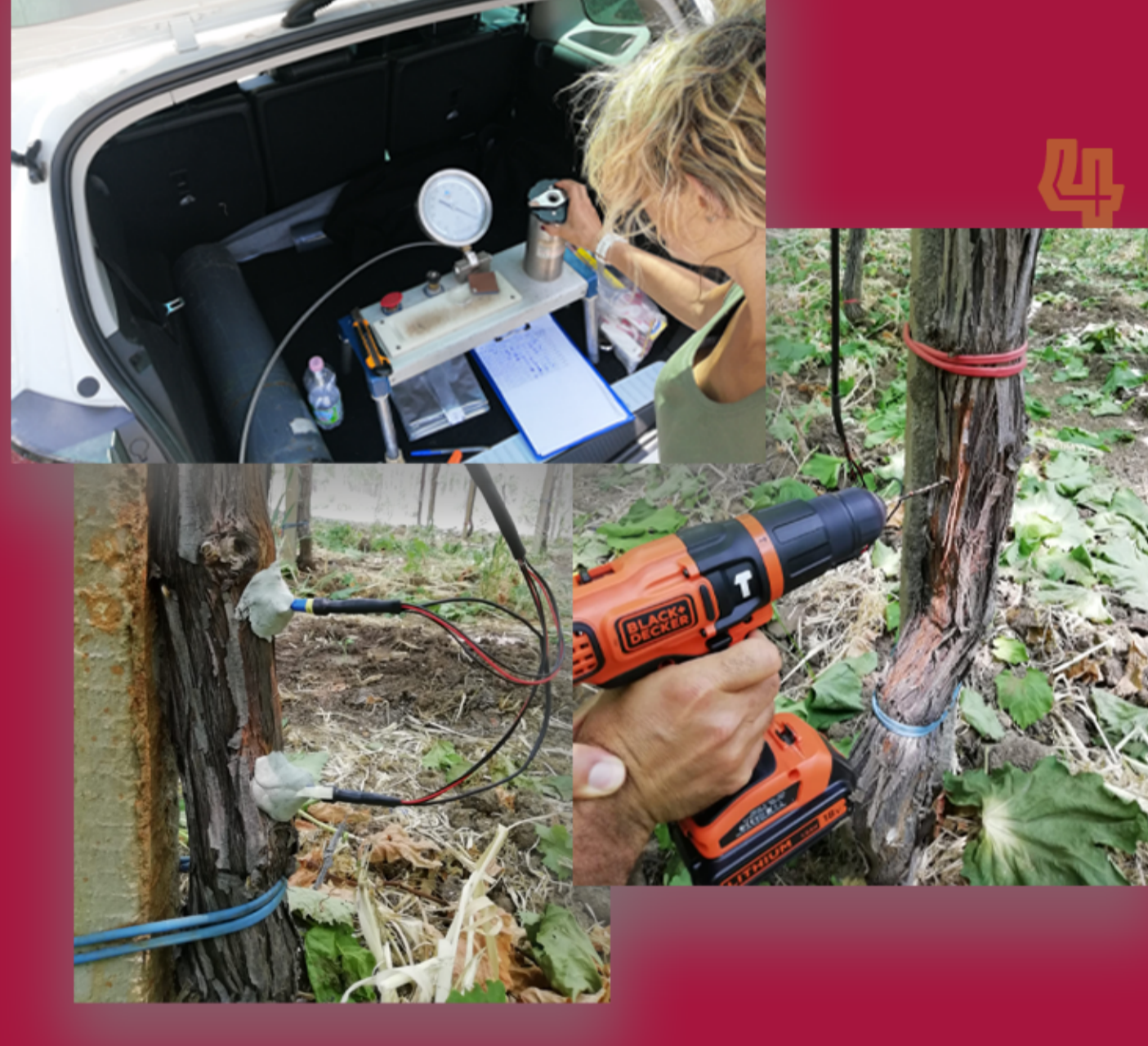
Figura 4. Monitoraggio del contenuto idrico del suolo (SWC) con sonde capacitivi.
